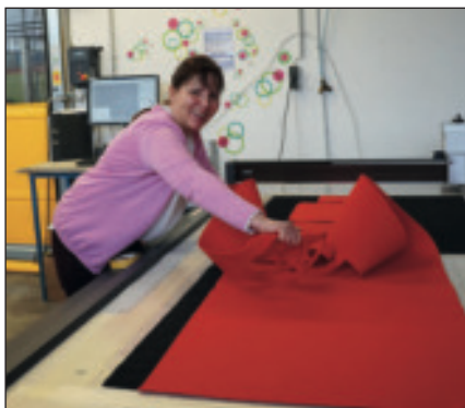
Edeltraud Moschner entfernt die überschüssige Auslegware, sodass nur noch die gewünschten Zuschnitte der einzelnen Taschenelemente auf der Anlage des Mimaki CF22-1225-Tisches übrig bleiben.
